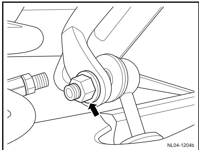
2) 安装后稳定杆与稳定杆连接杆连接的螺母。
